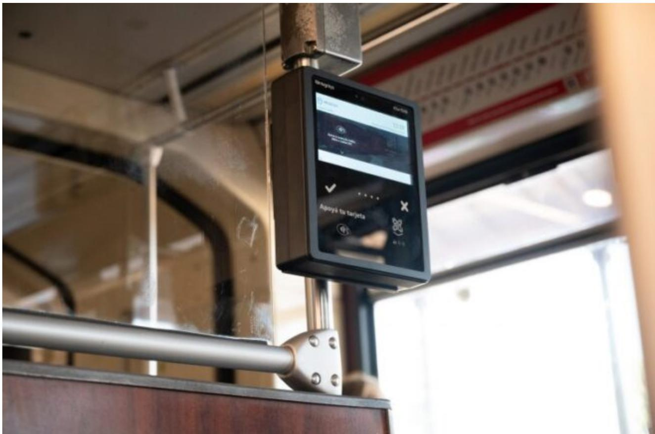
El usuario, al ascender a la dupla del Metrotranvía, realiza el pago en la máquina habilitada para este caso. El validador realiza las comprobaciones de seguridad del medio de pago presentado y habilita o rechaza el acceso en función de las reglas de seguridad y operación del sistema.
